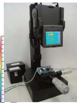
赤外線顕微鏡による故障・発熱解析
