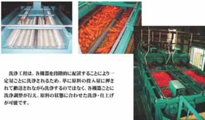
洗浄工程は、各機器を段階的に配置することにより一定量ごとに洗浄されるため、単に原料の投入量に押されて搬送されながら洗浄するのではなく、各機器ごとに洗浄調整が行え、原料の状態に合わせた洗浄・仕上げが可能です。
